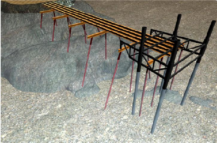
En esta representación se puede apreciar, como tocan el lecho marino cada uno de los pilotes en la construcción de un muelle multipropósito, ejecutado por constructora COMSA S.A. en la ciudad de Huasco para PUERTO LAS LOSAS.
